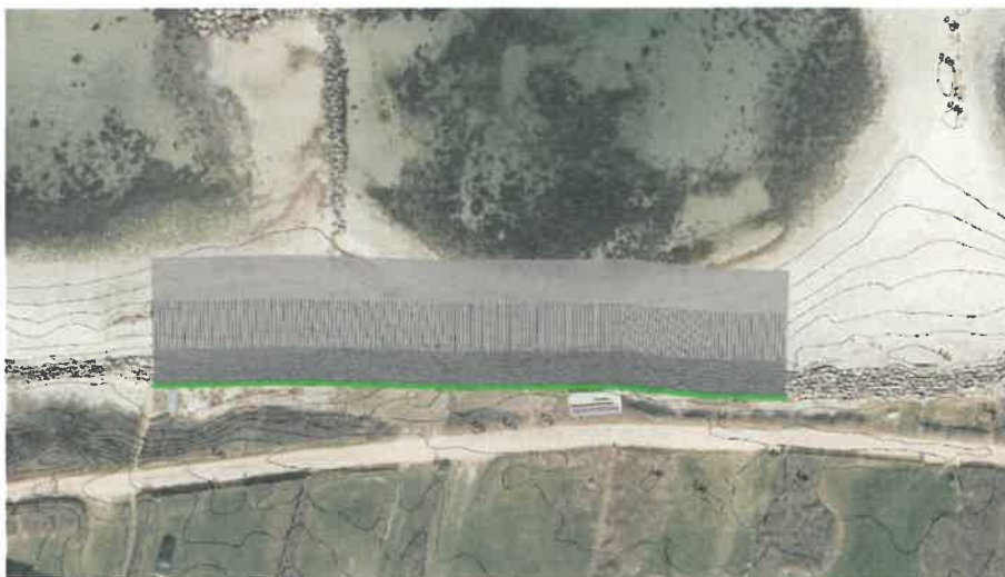
Figur 3.2: Strukturelt design af skråningsbeskyttelsen med krone, skrå del og tå i forhold til nuværende terræn i form af højdekoter med 50 cm ækvivalensdistance startende i kote 0,25 m DVR90. Hele tåen er derved dækket af sand og dele af den skrå del er også dækket ved samme terræn som i dag.
